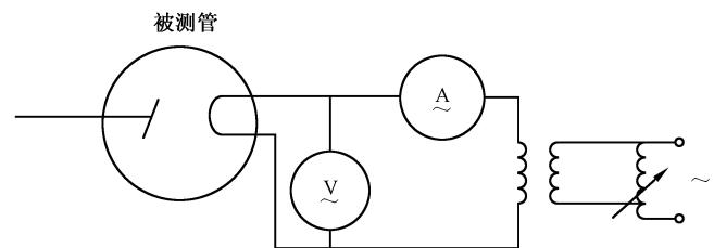
电压表内阻值应保证流经电压表之电流小于流经灯丝电流的 1%。
